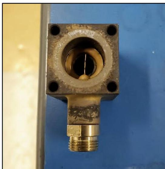
**FIGURE 31. FAILED CHIMNEY FROM FID ANALYZER**
